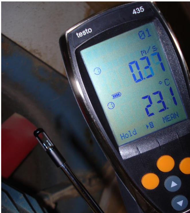
Anemometer misst Luftgeschwindigkeiten und Lufttemperaturen
